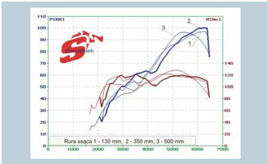
Rys. 2. Wykres momentu i mocy silnika dla różnych długości rur ssących.
